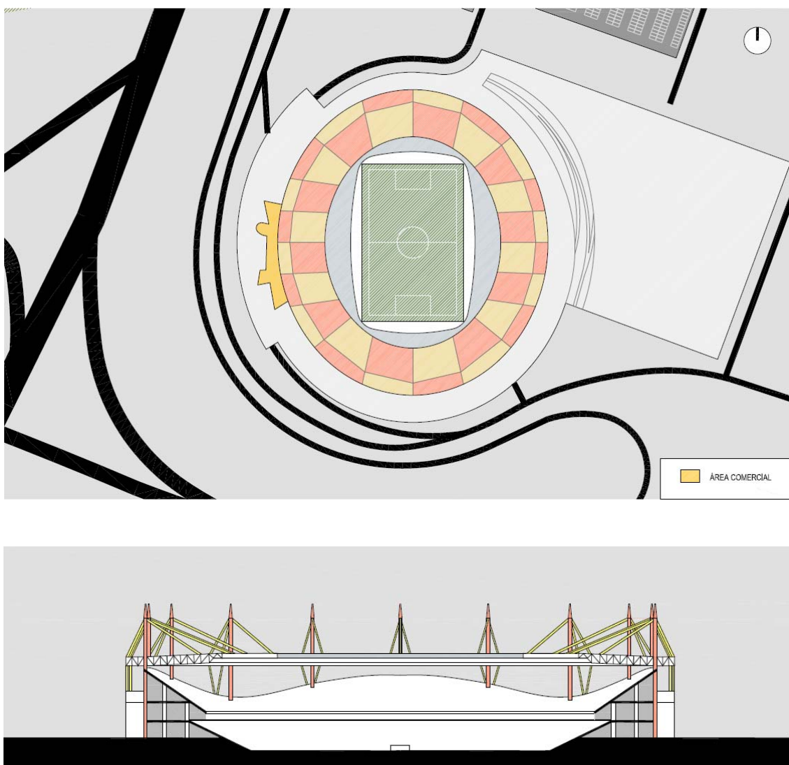
Fig. 33 – Planta do complexo do estádio e corte esquemático da tipologia do Estádio Municipal de Aveiro [Fonte: Autor]
